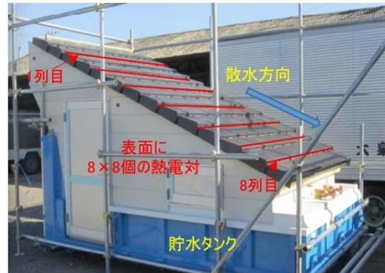
図-1 屋根散水システムの実験施設
