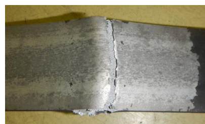
図-3 t=12\text{mm} , M=12\text{g} (変形・亀裂／剥離)
