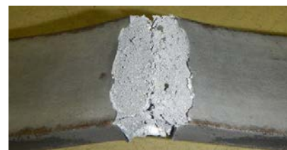
図-4 t=12\text{mm} , M=18\text{g} (変形・亀裂／剥離)
