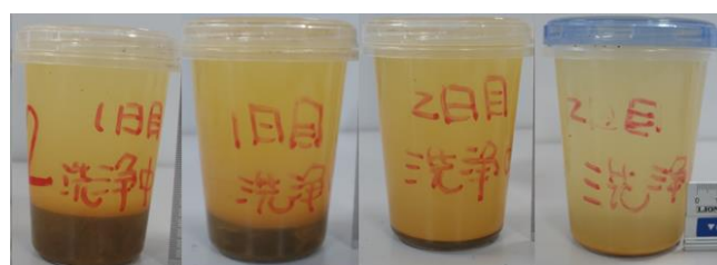
写真-2 使用した洗浄排水
