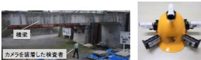
図-1 目視検査時の撮影の例<sup>3)</sup>
