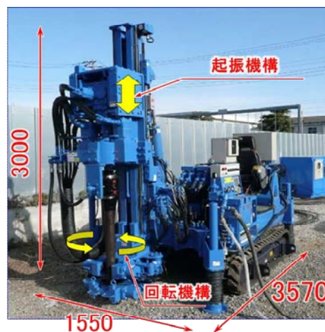
写真-1 e-コラム杭施工に用いる 削孔機
