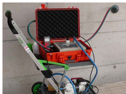
写真 1 トレント式透気試験機
