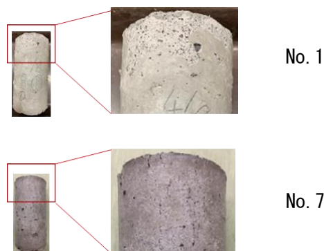
図3 水結合材比の違いによる供試体劣化状況 (硫酸浸漬期間28日)
