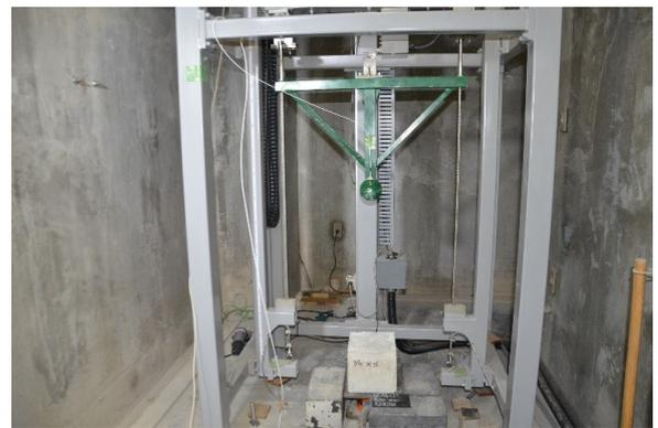
写真-1 重錘落下装置と供試体
