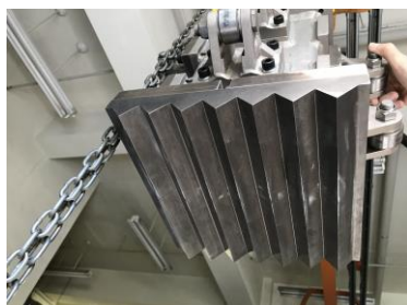
写真-1 擦過実験用重錘下面の刃
