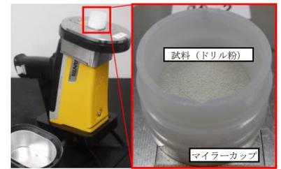
図1 ハンドヘルド型蛍光X線分析計による測定状況
