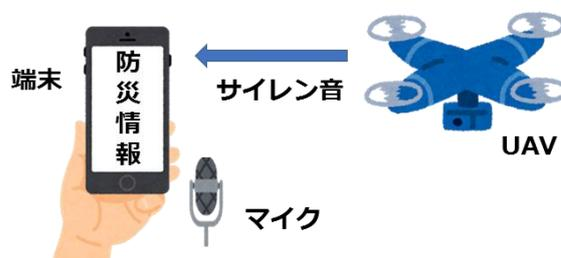
図2 提案する防災情報伝達システムの概念図
