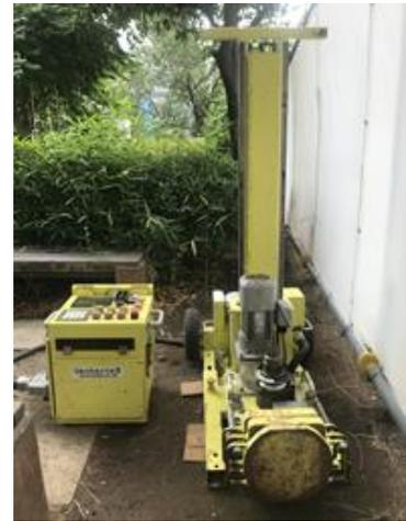
写真1 SDS 試験
