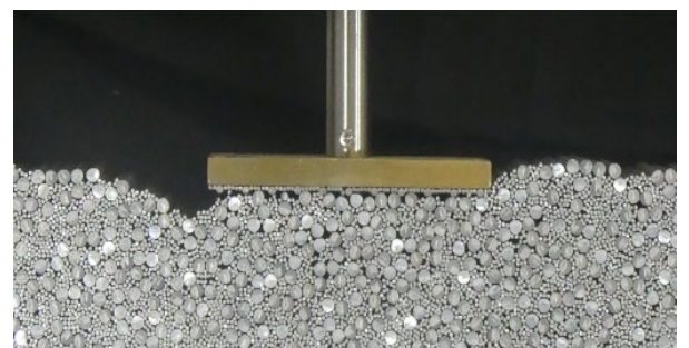
図-7 局所洗掘範囲の基礎底部にアルミ棒が移動した様子 ( W_s=40\text{mm} 沈下量 6mm 時)
