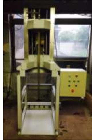
写真-1 機械攪拌装置
