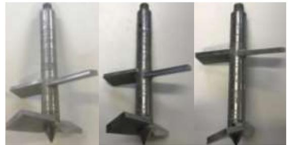
写真-2 攪拌翼の形状
