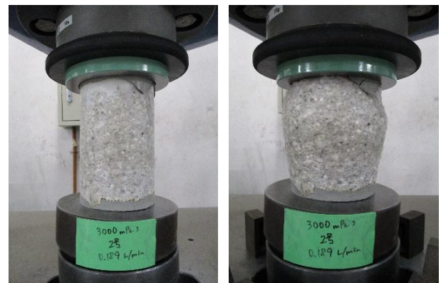
図 3.4 一軸圧縮試験時の様子 (左: 試験前, 右: 試験後)
