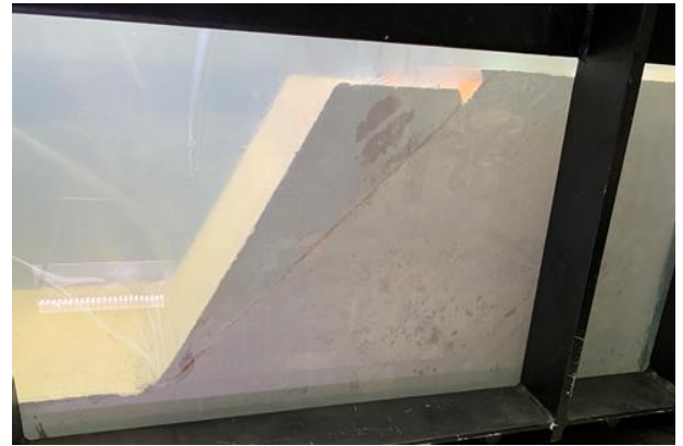
図-2 側面から見た崩壊後の様子
