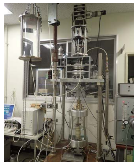
図3 三軸圧縮試験装置
