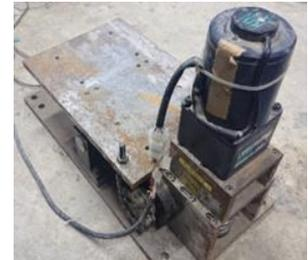
写真-1 遠心場震度法シミュレータ
