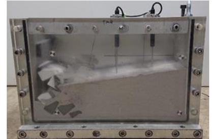
写真-5 実験後の模型擁壁
