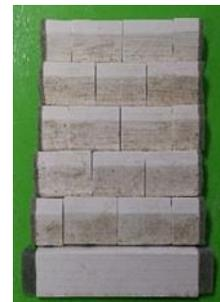
写真-2 使用した擁壁ブロックと基礎
