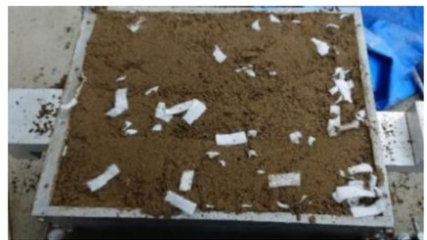
写真-2 作製した大型一面せん断試験の供試体
