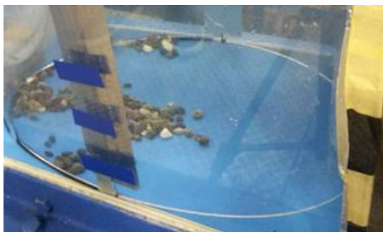
写真2 マンホール内の流況( d=15\text{cm} , case5)
