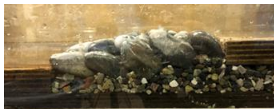
写真-1 礫を設置した状態 H/T=0.14
