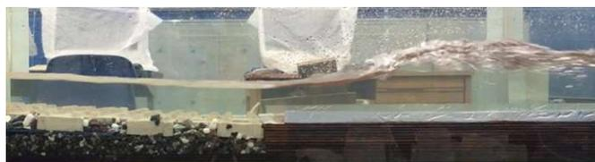
図2 水面に沿う流れ ( $F_1=1.00$ ,  $h_m/h_1=0.79$ ,  $h_d/h_1=1.44$ )
