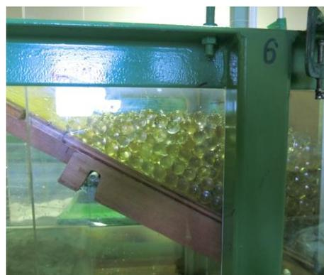
図-2 材料（ガラス球10mm）を積載した様子
