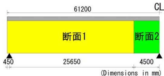
図-1 2 径間連続合成桁の解析モデル
