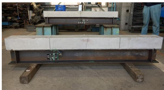
写真2 荷重試験後の試験体 (手前：ケース2 奥：ケース1)
