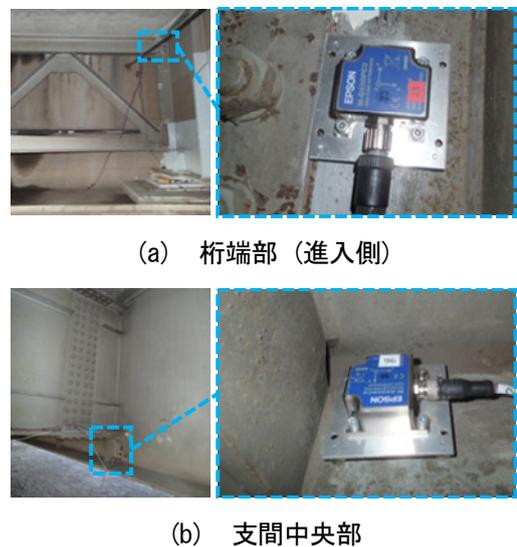
図-2 加速度センサの設置状況
