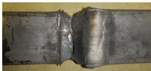
図-4 引張力が作用して破断された鋼材の例( $t=12\text{mm}$ ,  $W=50\text{mm}$ ,  $M=40\text{g}$ )
