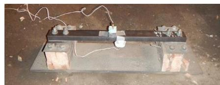
図-2 爆薬を設置した鋼材
