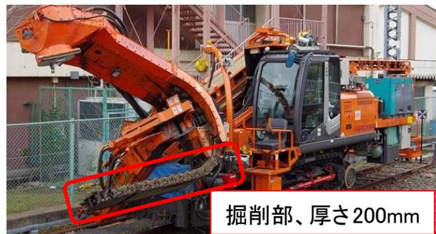
図-4 道床掘削機概要
