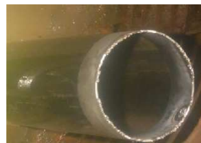
図-6 ベビーモール工法先端ビット
