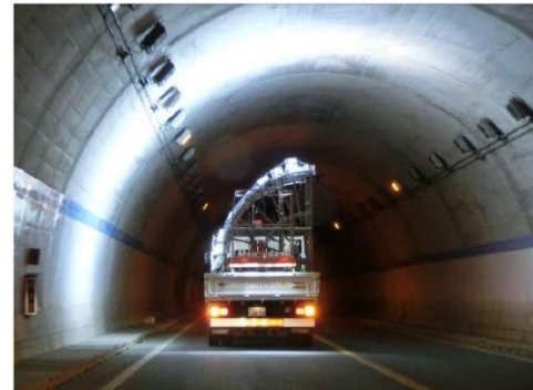
図-1 走行型画像撮影技術を用いた点検車両
