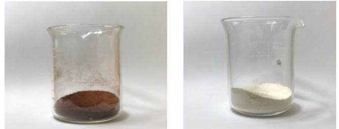
写真3 沈殿物(中和後) 写真4 沈殿物(炭酸化後)
