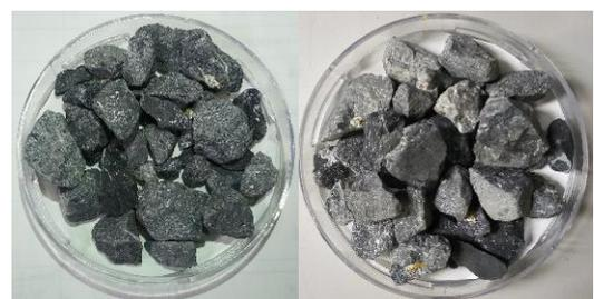
(c) 1サイクル目 再生粗骨材 (d) 2サイクル目 再生粗骨材
