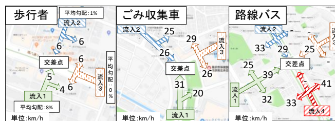
図-3 高密度なプローブデータを用いた検証結果
