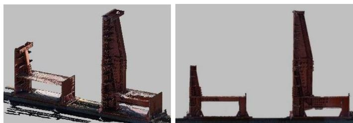
図 2 レーザスキャナによる三次元点群モデル
