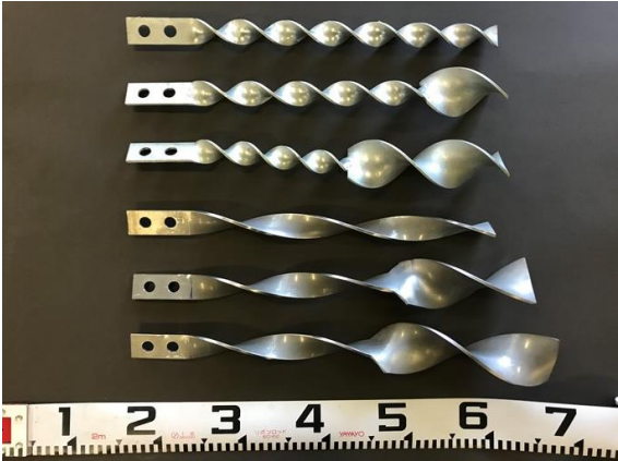
写真-1 拡径スパイラルパイル
