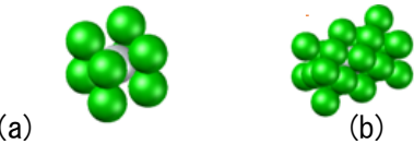
図7 体心立方格子(a)と面心立方格子(b)
