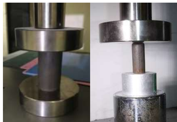
写真4 一軸圧縮試験
