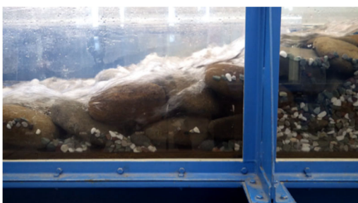
写真6 平石積みの流況 (hc=6.6 cm)
