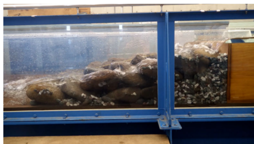
写真4 平石積みの流況 (hc=3.3cm)
