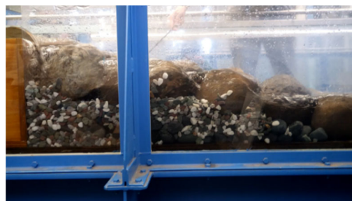
写真5 丸石積みの流況 (hc=3.3cm)
