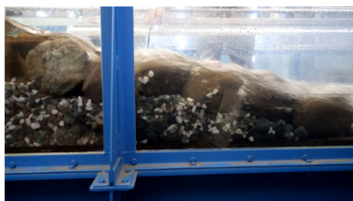
写真7 丸石積みの流況 (hc=6.6 cm)
