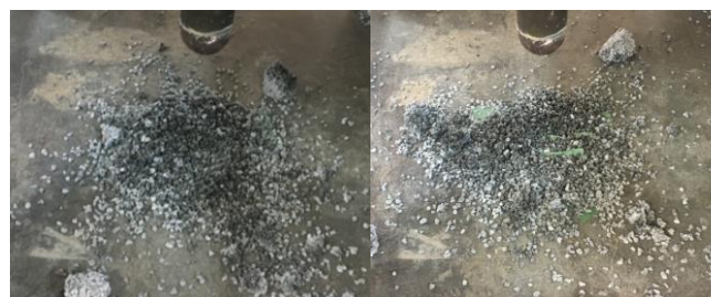
写真－2 V_m/V_g=5V_o1\% の供試体破壊状況
