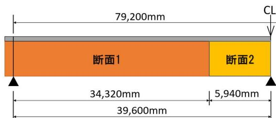
図-2 2径間連続合成桁の解析モデル
