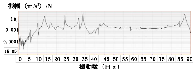
図 5 伝達関数 (D 点加振，測点 6 応答)
