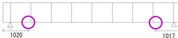
図5 下フランジ継ぎ部位置 (mm)
