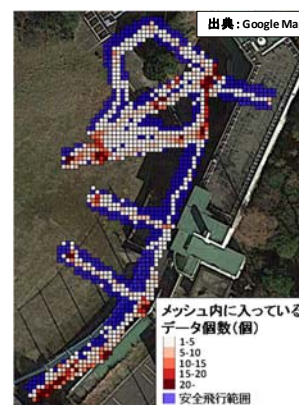
図-4 風による飛行影響箇所の可視化結果
