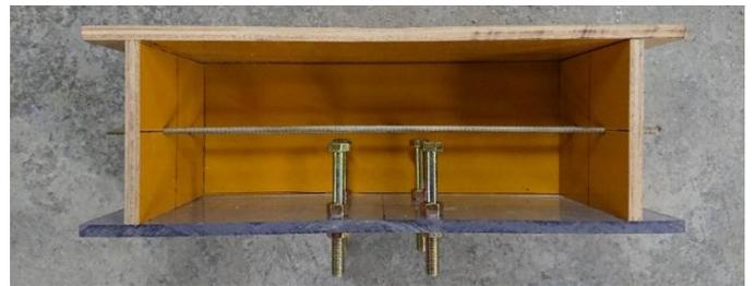
写真2: 通水試験に使用する供試体の自作の型枠
