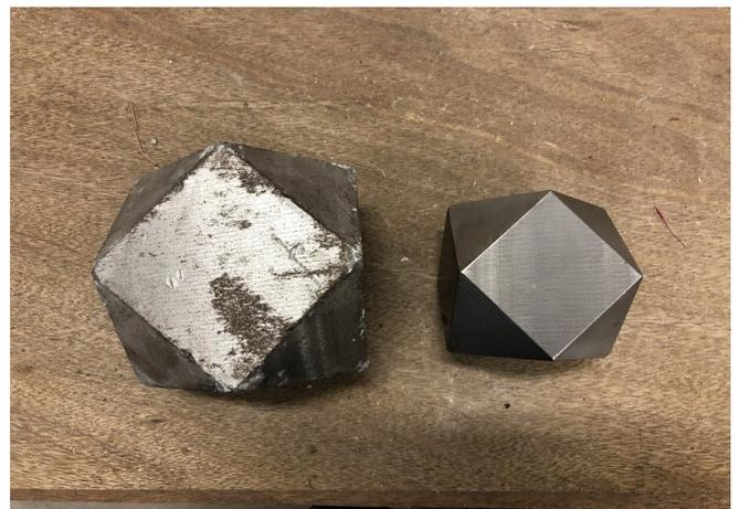
写真-1 立方八面体の重錘
