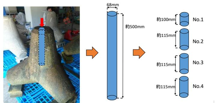
図-1 試験体外観およびコア採取箇所
