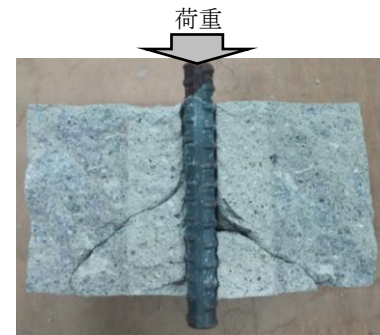
図-6 D13 の場合の破壊面
