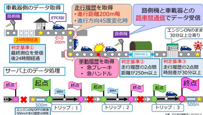
図-1 ETC2.0 プローブ情報の取得および処理の過程
