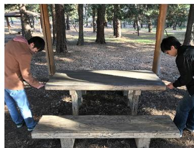
図9 鋼巻尺による机の実測
