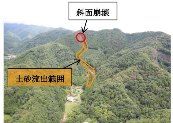
図 - 2 斜面崩壊と土砂流出範囲
