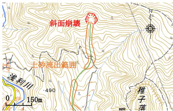
図 - 3 斜面崩壊と土砂流出範囲の平面図
